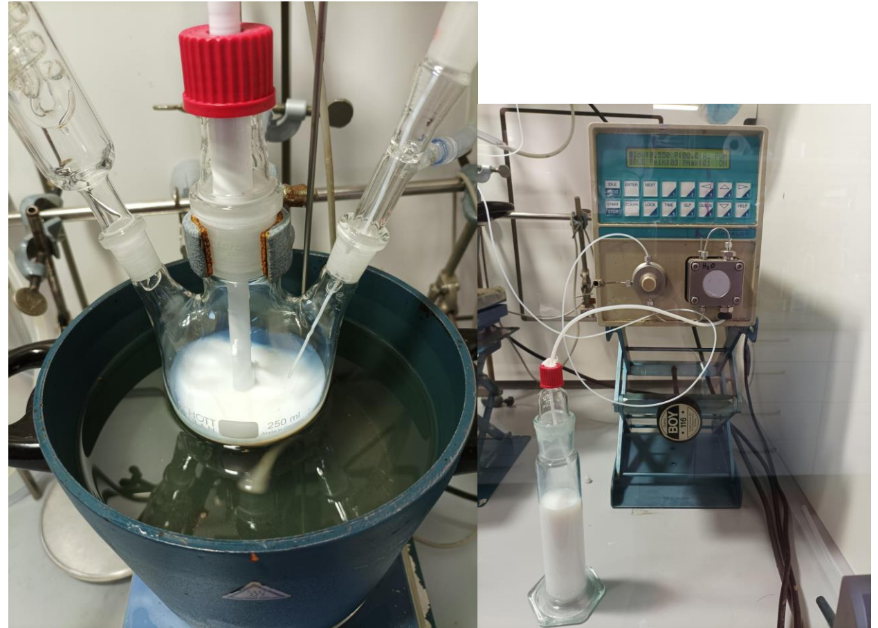
Emulsionspolymerisation (links), und emulgierter Monomerfeed mit Dosierpumpe (rechts).
