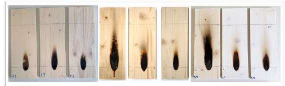
Abbildung 8: Fotos nach der Brandprüfung PAC, PU, PVAC (links -> rechts: 0%, 10%, 25% FSM)
