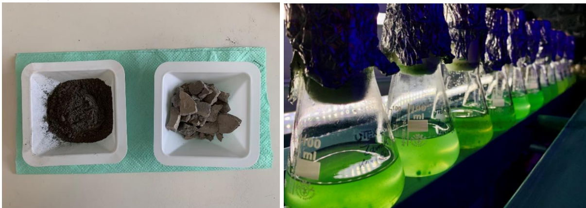
Abb. 1: Erzeugtes Struvit (links aus Schweineurin und rechts aus Rinderurin) Phosphatgehalt beträgt 1,80 g/100g (Schwein) bzw. 26,64 g/100g (Rind) (Gesamt P205) (linke Abb.); Versuchsreihe mit Struvit und Arthrospira platensis im Rahmen des Projektes (PhycoKult) (rechte Abb.). Abbildungen AWI (A. Beyer).
